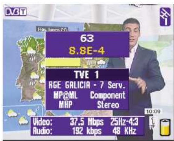
Obr. 57 Rozšířené okno měření
