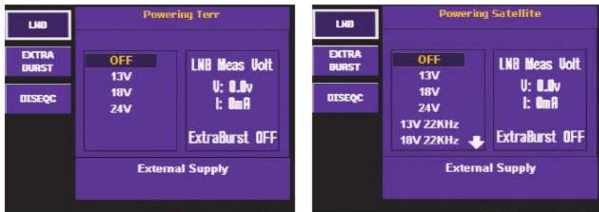
Obrázek 13: Napájení do RF-IN vstupu
